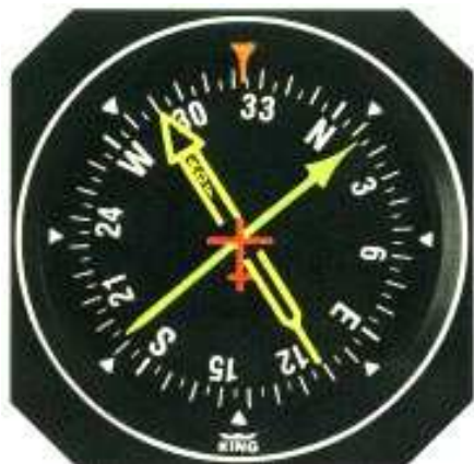
Sl. 6.5 Prikazovalnik radijskega kompasa
