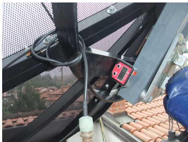
Slika 3.1: Umerjanje teleskopa s pomočjo kotomera
