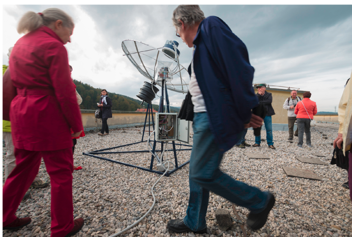
Šentviški teleskop je namenjen sprejemanju radijskega sevanja hladnega vodika (pretežno iz naše Galaksije). Foto: Andrej Guštin
